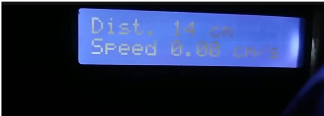
Figure 64 L'affichage de la distance et la vitesse (speed) de l'objet détecté sur LCD.
