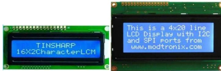
Figure 24 Afficheurs LCD : (a) (16x2), (b) (20x4)
