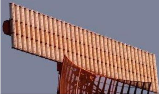
Figure 2 Antenne radar primaire celle en bas ([www.radartutorial.eu](http://www.radartutorial.eu))
