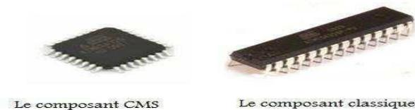
Figure 16 Microcontrôleur ATmega328
